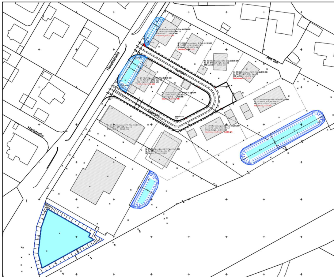
Abbildung 4: Straßenplanung und Muldenlage/ -größe (Entwurf: Glatz & Kraus Ingenieure, Stand: 23.03.2026)
